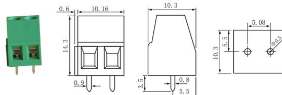
PCB板直焊式压接端子，间距5.08
